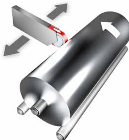
Шлифование деталей на опорном ролике
