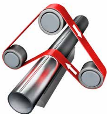
Шлифование сварного шва при производстве труб
