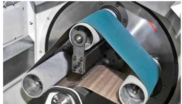
Снятие окалины с катанки при помощи планетарного метода шлифования
