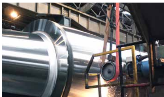
Шлифование деталей на опорном ролике
