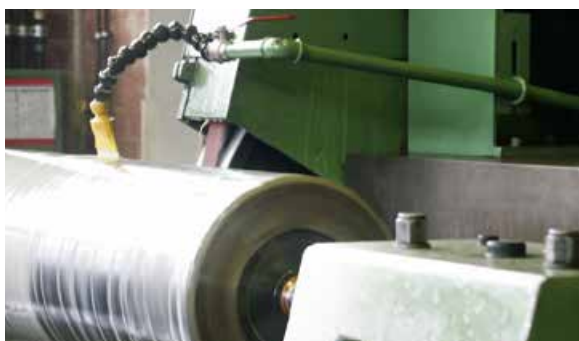
Шлифование деталей, закрепленных в центрах
