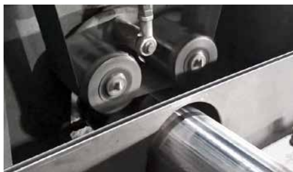
Шлифование сварного шва при производстве труб
