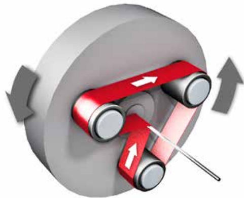
Снятие окалины с катанки при помощи планетарного метода шлифования
